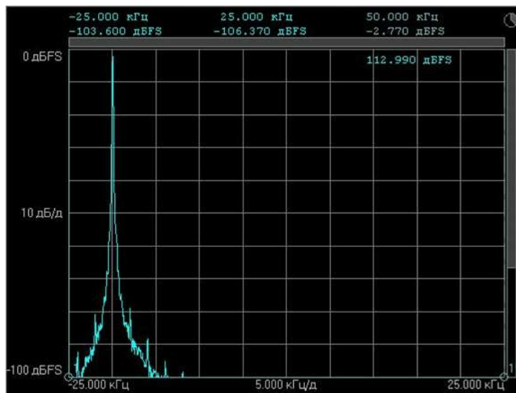
Рисунок 6. Входной сигнал в полосе 50 кГц, используется Г4-176.
