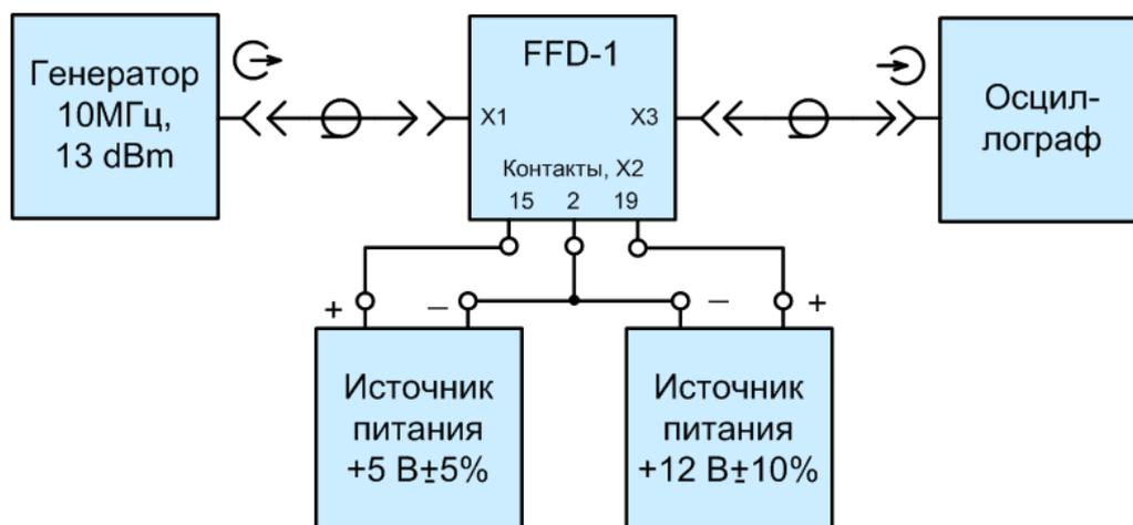
**Рис.9** Схема проверки модуля FFD-1
